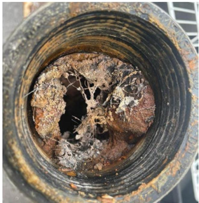
Zugesetzte Grauguss-Rohre durch Korrosion oder auch Ablagerungen.
