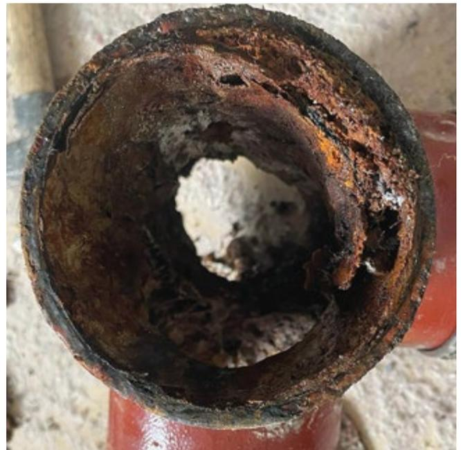
Hier an diesen Rohren sind die typischen Erscheinungsformen des Rohrfraß zu erkennen.
